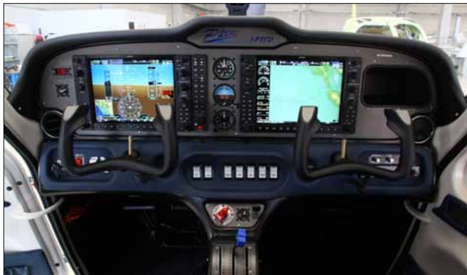
Moderně řešený glass cockpit s avionikou Garmin 1000.
