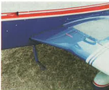
Stupačka před křídlem umožňuje snadné nastupování
